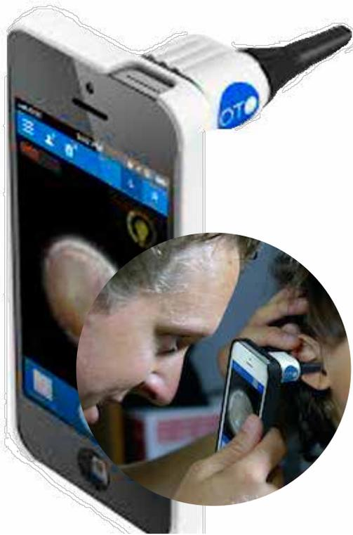
La empresa CellScope desarrolló un dispositivo que cumple la función de un otoscopio y se puede adaptar al iPhone. Puede ser utilizado por los médicos como herramienta para diagnosticar problemas en el oído.
